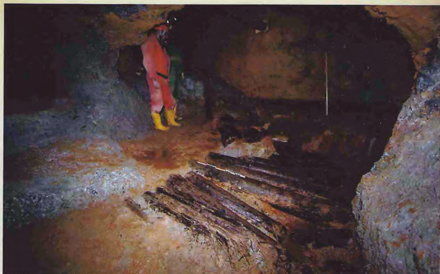
Fig. 2: Armătură romană (sec. II d.Ch) conservată în tavanul galeriei G25; foto C. Tămaș.
