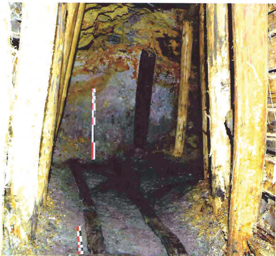
Fig. 1: Cale ferată din lemn de epocă modernă, prevăzută cu macaz (galeria GM21); foto B. Cauuet.
