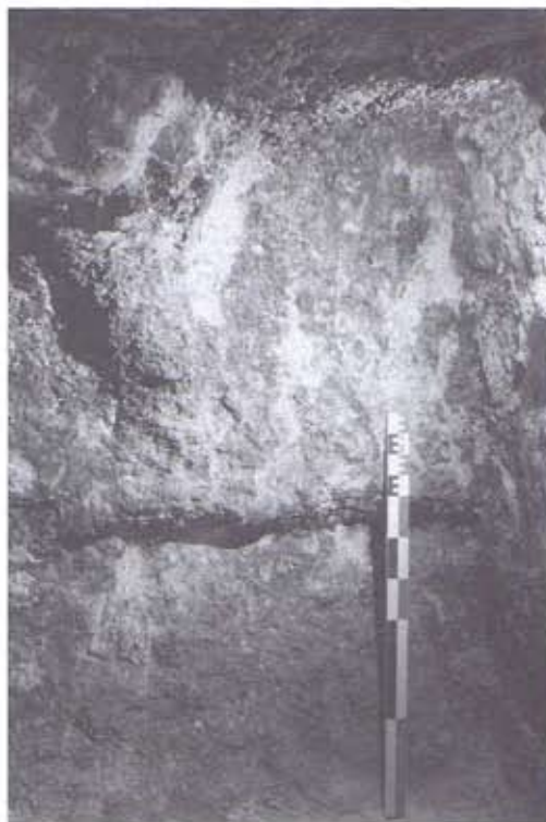
Fig.14 : Front de taille de la galerie G36 marqué d'un prélèvement de roche de section quadrangulaire (rainurage pour échantillonnage) dans Cârnic9-Inférieur.
