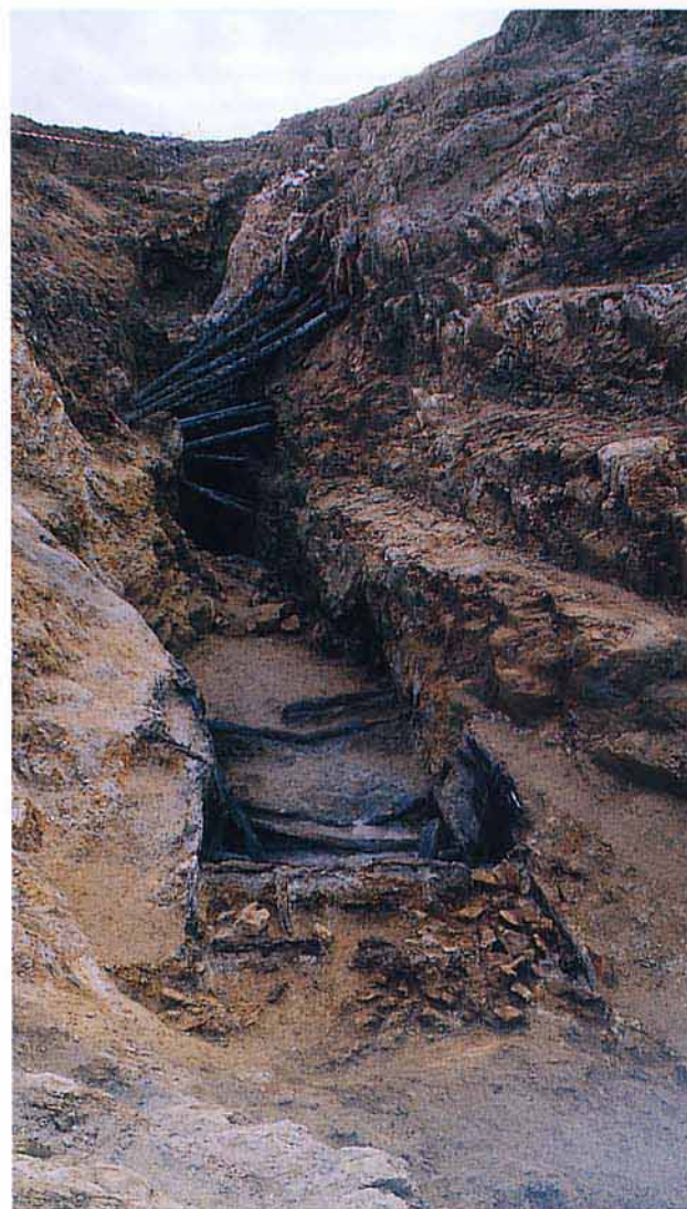
Fig. 36 - Intérieur d'une excavation en cours de fouille à la mine de La Fagassière (Château-Chervix, Haute-Vienne). À droite, les gradins laissés par l'exploitation ; au centre, le haut d'un dépilage avec boisages en cours de dégagement ; au premier plan, une plate-forme en remblais.
