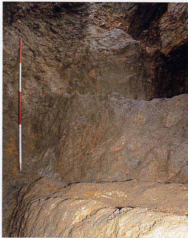
Fig. 30 - Dépilage avec paroi taillée en gradins à la mine d'or des Fouilloux (Jumilhac-le-Grand, Dordogne).
