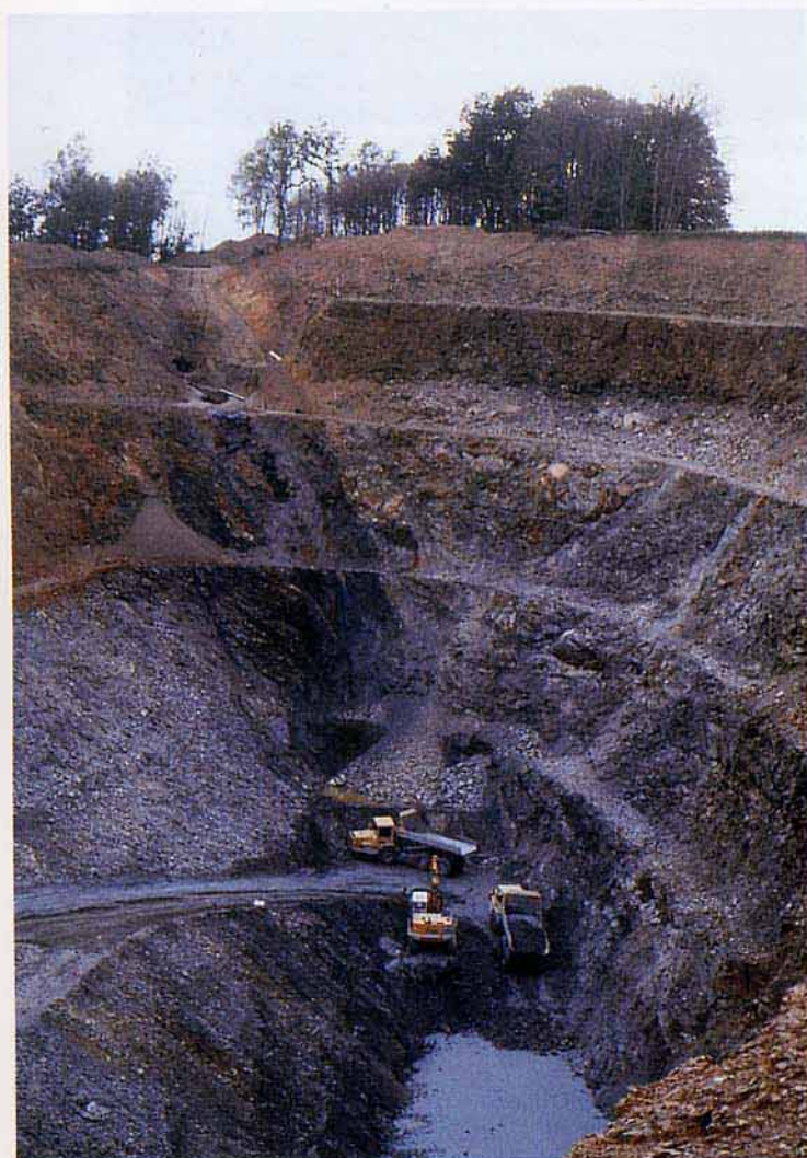
Fig. 22 - Filon de quartz aurifère gris bleuté visible dans la mine d'or à ciel ouvert en cours de réexploitation au site des Fouilloux (Jumilhac-le-Grand, Dordogne). Au sommet de l'excavation, on distingue encore les vestiges de la mine gauloise fouillée en sauvetage de 1988 à 1994.
